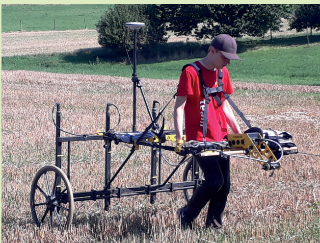
GPS-gestütztes Magnetometer im Geländeeinsatz auf einer archäologischen Fundstelle.
